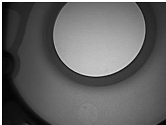
图 14 优化后的曲轴油封孔 X 光检测图
